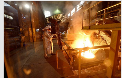
Coulage de métal en fusion dans une fonderie
